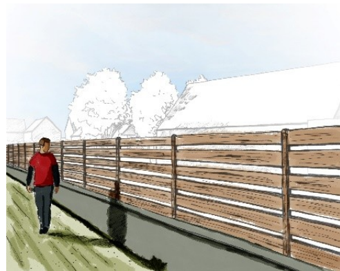
Mur surmonté d'un dispositif à claire-voie
