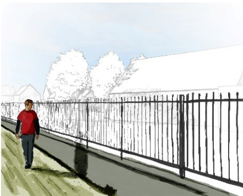
Mur bahut surmonté d'une ferronnerie
